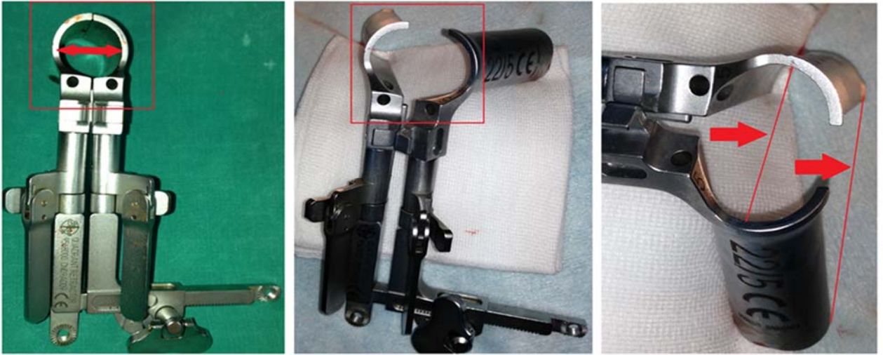
Рисунок 38 – Дислокация лепестков ретрактора MAST Quadrant (стрелками указан диаметр: слева – верхний диаметр порта без разведения и дислокации лепестков ретрактора, справа – верхний и нижний диаметр порта с дислокацией)
