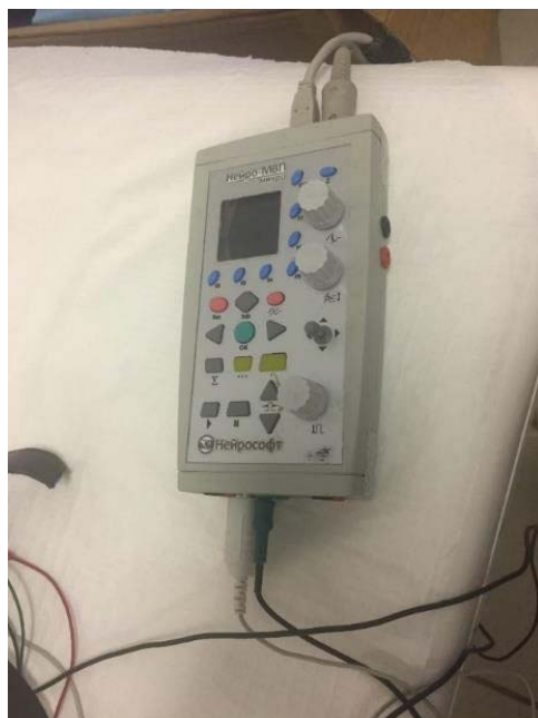
Рисунок 4 — Электронейромиограф «Нейрософт нейро-МВП микро»
